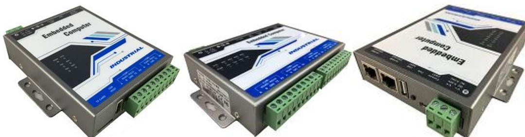
网关在应用现场通过接口和传感器、仪表、PLC 等设备连接，使用协议实时采集终端设备的运行数据，并把采集到的数据保存到设备中的 SD 卡上。
