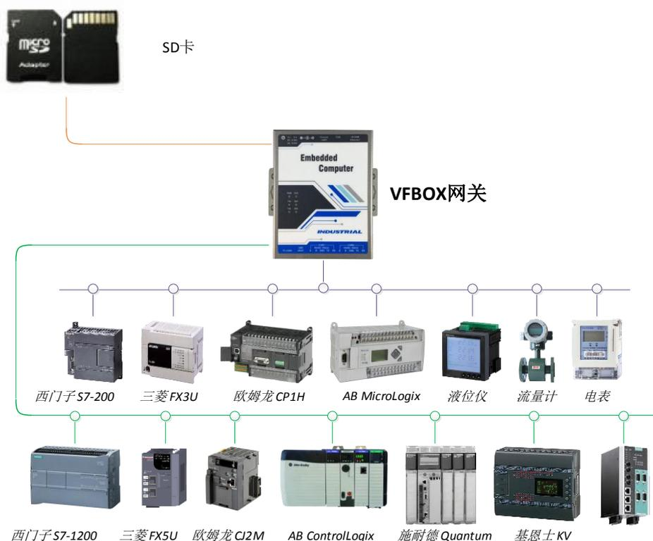
网关支持多种工业设备的通信协议，支持的通信协议（部分）如下。同时，网关还可以对采集的数据建立表达式，进行数学、逻辑判断等操作。
